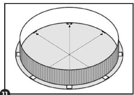
б. После выравнивания проверьте, не сместились ли профили в направляющих. Если необходимо, отцентрируйте их, оставляя зазор 13 мм.
