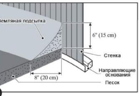
б. Для подсыпки можно использовать просеянную землю или песок. После засыпания песок или землю нужно тщательно утрамбовать и придать закруглённую форму.
